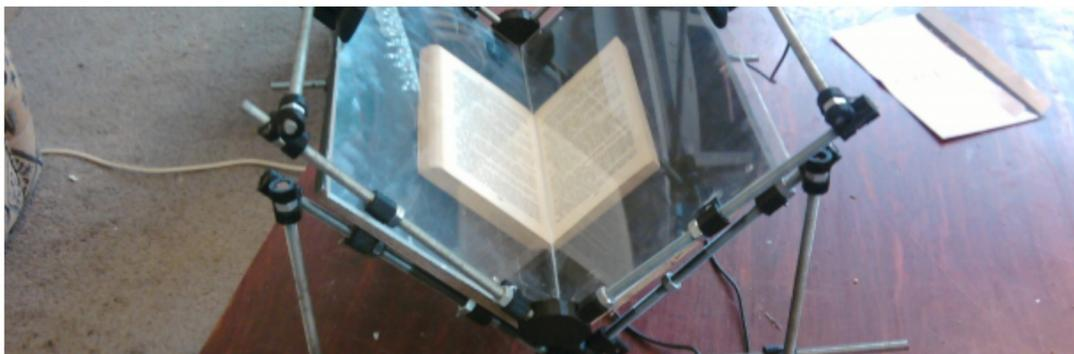
*Imagen N° 7 : implementación de un sistema anticurvatura de páginas con vidrios en V.*
