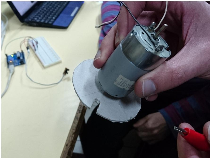
*Imagen N°22: motor de corriente continua de 24V de impresora.*
