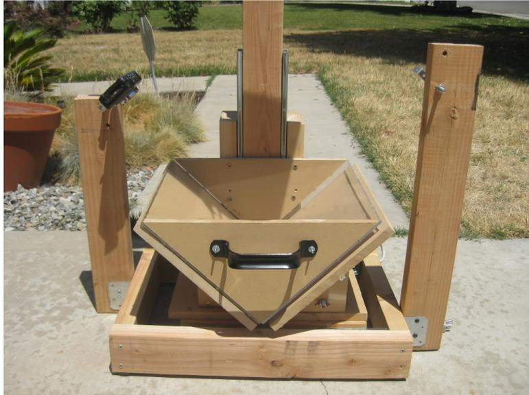
*Imagen N° 1 : disposición típica de scanner para libros de construcción casera.*
